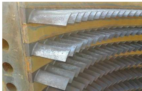
تخریب سطح پره های کمپرسور:
